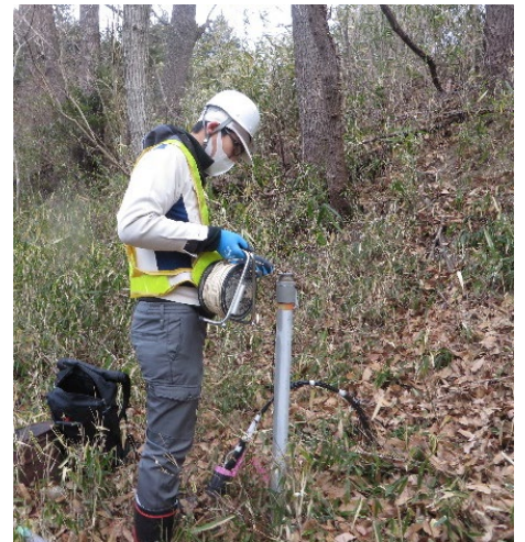
ダム右岸鞍部での観測 (地下水位観測)
